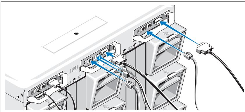
Verbinden Sie das serielle Kabel und das bzw. die Netzkabel vom Verwaltungssystem mit dem CMC-Modul. Wenn ein optionales zweites CMC-Modul installiert ist, schließen Sie es ebenfalls an.
