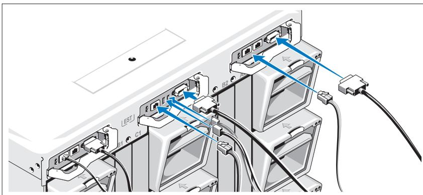
Připojte sériový kabel a síťové kabely z řídicího systému k modulu CMC. Připojte také druhý, volitelný modul CMC (pokud je nainstalován).
