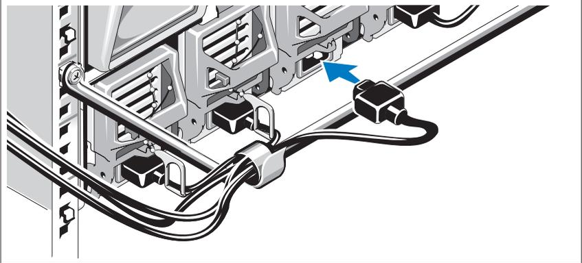
Připojte napájecí kabely systému ke zdrojům napájení.
