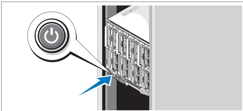
Stiskněte tlačítko napájení na šasi. Měl by se rozsvítit indikátor napájení.
