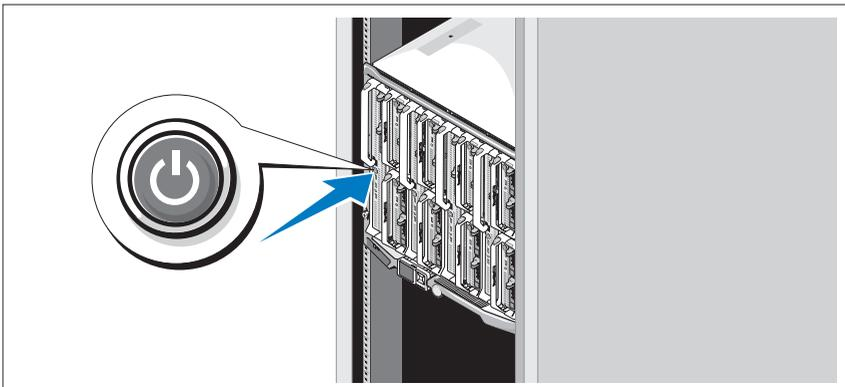
Drücken Sie an jedem Blade den Netzschalter, oder schalten Sie die Module über die Systemverwaltungssoftware ein.
