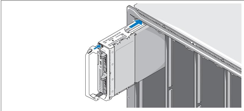
Empezando por la parte superior, inserte los módulos en el alojamiento de izquierda a derecha. Una vez que el módulo de alta densidad esté bien instalado, el asa volverá a la posición de cierre.
