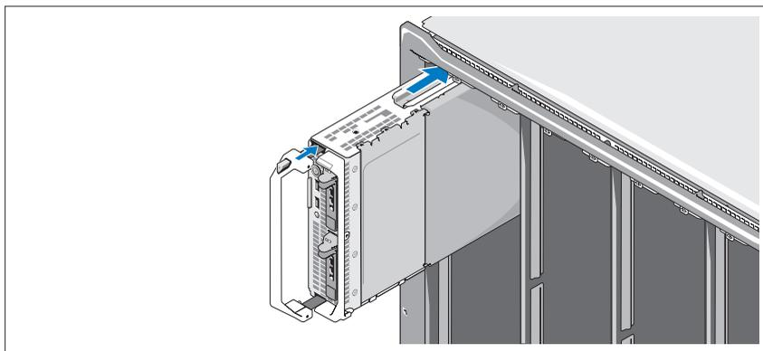
Начиная сверху, вставляйте модули в модульный корпус слева направо. После правильной установки модуля ручка вернется в закрытое положение.
