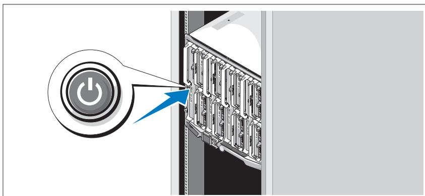
Mettez chaque lame sous tension en appuyant sur son bouton d'alimentation ou en utilisant le logiciel de gestion des systèmes.
