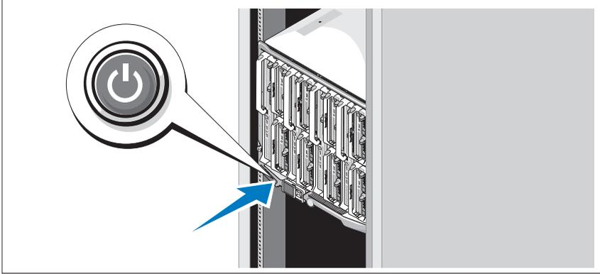
Kasanın üzerindeki güç düğmesine basın. Güç göstergesi yanmalıdır.
