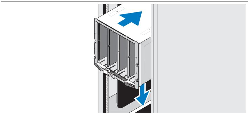
Assemblez les rails et installez le système dans le rack en suivant les consignes de sécurité et les instructions d'installation du rack fournies avec votre boîtier.
