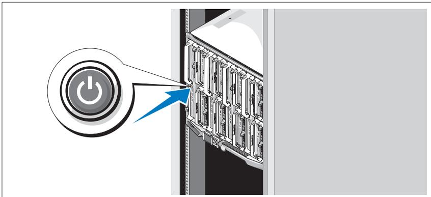
Pulse el botón de encendido de cada módulo de alta densidad o encienda los módulos mediante el software de administración de sistemas.
