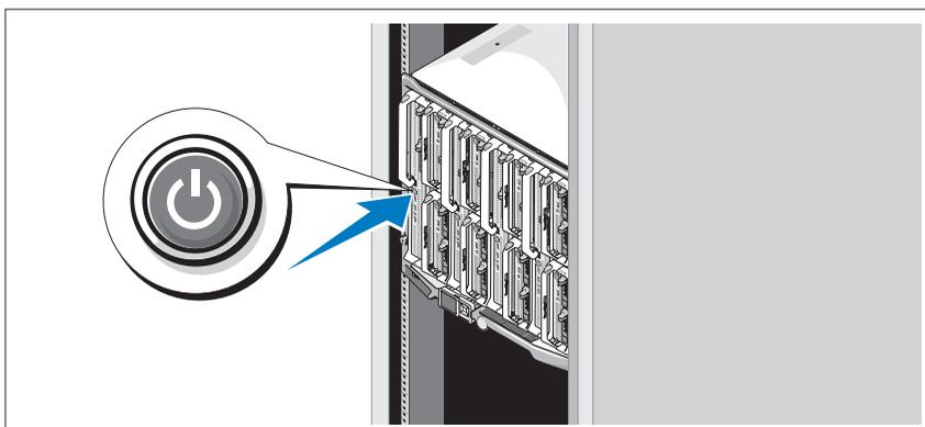
Stiskněte tlačítko napájení na každém modulu blade nebo spusťte napájení modulů blade pomocí softwaru pro správu systémů.
