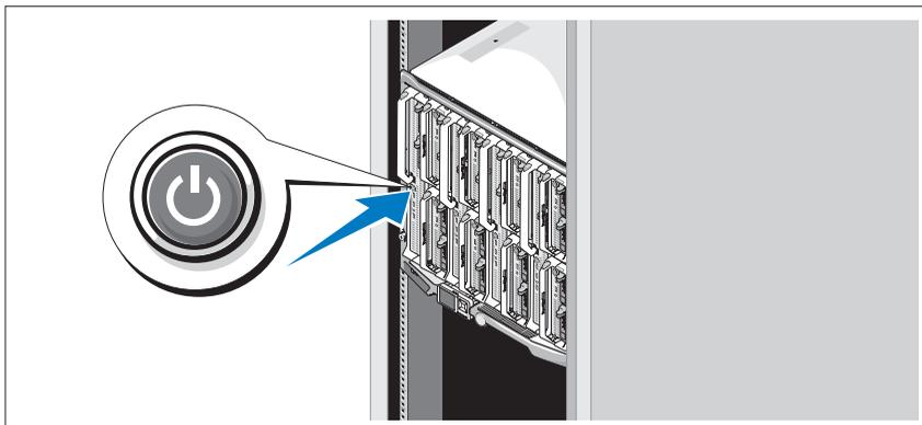
Нажмите кнопку питания на каждом серверном модуле или включите питание модулей с помощью программного обеспечения для управления системами.
