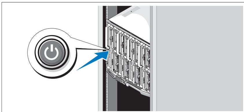
Naciśnij przycisk zasilania na każdym serwerze kasetowym lub uruchom serwery za pomocą oprogramowania do zarządzania systemem.
