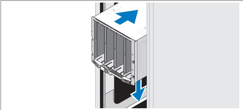
Συναρμολογήστε τις ράγες και εγκαταστήστε το σύστημα σε ράφι σύμφωνα με τις οδηγίες ασφάλειας και τις οδηγίες εγκατάστασης σε ράφι που παρέχονται με τον εξοπλισμό σας.
