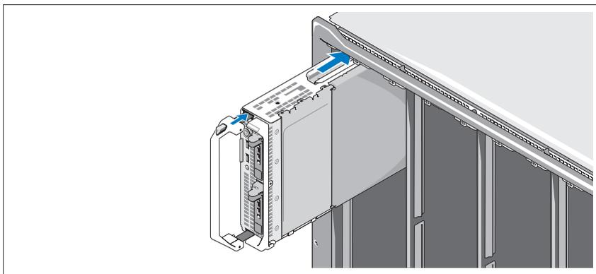
Postupujte zleva doprava a shora dolů a zasouvejte moduly do šasi. Jakmile je modul blade bezpečně nainstalován, držadlo se vrátí do zamčené pozice.
