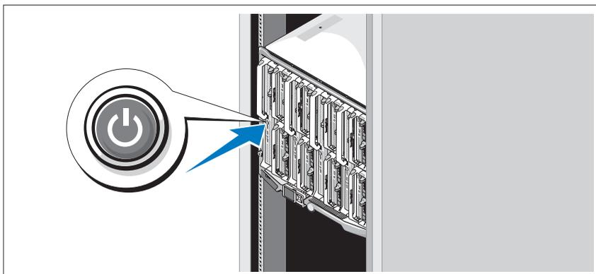
Πιέστε το κουμπί τροφοδοσίας σε κάθε μονάδα ή ενεργοποιήστε τις μονάδες χρησιμοποιώντας το λογισμικό διαχείρισης συστημάτων.
