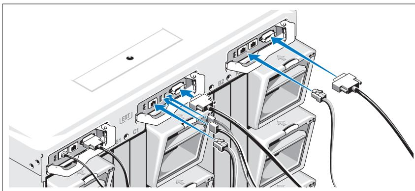
Подключите систему управления к модулю контроллера шасси с помощью последовательного и сетевого кабелей. При наличии дополнительного модуля контроллера шасси подключите и его.
