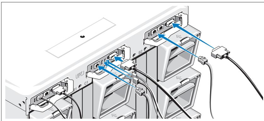
Podłącz kabel szeregowy i kable sieciowe z systemu zarządzania do modułu CMC. W przypadku instalowania drugiego, opcjonalnego modułu CMC należy go również podłączyć.
