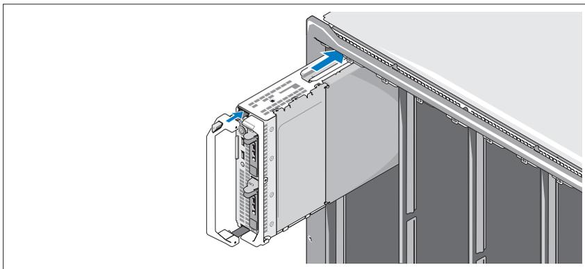
Wsuwaj moduły do obudowy począwszy od góry, od lewej do prawej strony. Gdy serwer kasetowy zostanie poprawnie zainstalowany, uchwyt powróci do pozycji zamkniętej.
