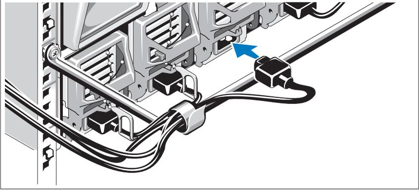
Sistemin güç kablolarını sistemin güç kaynaklarına bağlayın.
