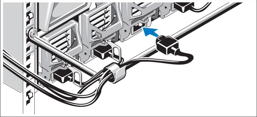
Podłącz kable zasilania systemu do zasilaczy systemu.
