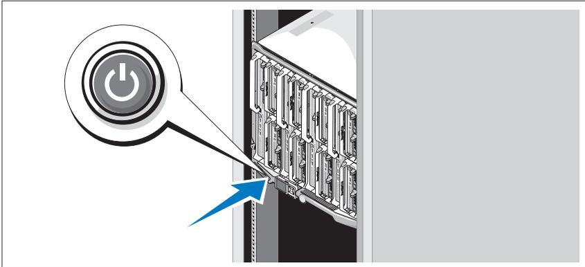
Drücken Sie den Netzschalter am Gehäuse. Daraufhin sollte die Betriebsanzeige aufleuchten.
