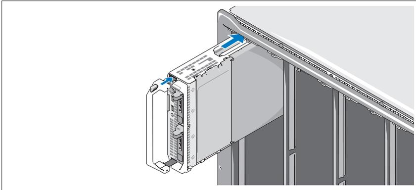
Beginnen Sie oben mit dem Einsetzen der Module, und schieben Sie sie von links nach rechts in das Gehäuse. Wenn das Blade korrekt im Gehäuse installiert ist, kehrt der Griff in die geschlossene Position zurück.
