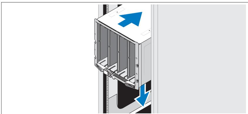
Смонтируйте направляющие и установите систему в стойку согласно инструкциям по технике безопасности и инструкциям по установке стойки, которые поставляются с корпусом.
